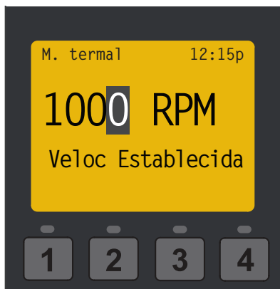
Configuración de la velocidad de la bomba en modo Thermal
